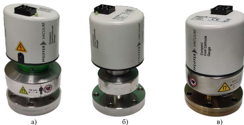
Рисунок 2. Конструкции датчиков с установленными на них электронными блоками Pfeiffer: а) – аналог датчика IKR 270, б) – двойной инверсно-магнетронный датчик, в) – оригинальный датчик IKR 270.
