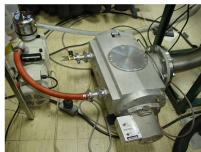
Рисунок 1. а) вакуумная камера из нержавеющей стали б) механический и турбомолекулярный насосы.
