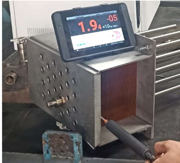
Рисунок 2. Измерение герметичности газовым масс-спектрометрическим методом способом щупа. Модель ТА в собранном виде.
