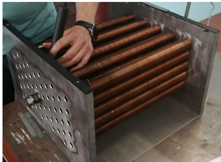
Рисунок 4. Испытания модели ТА с оребренными трубами.
