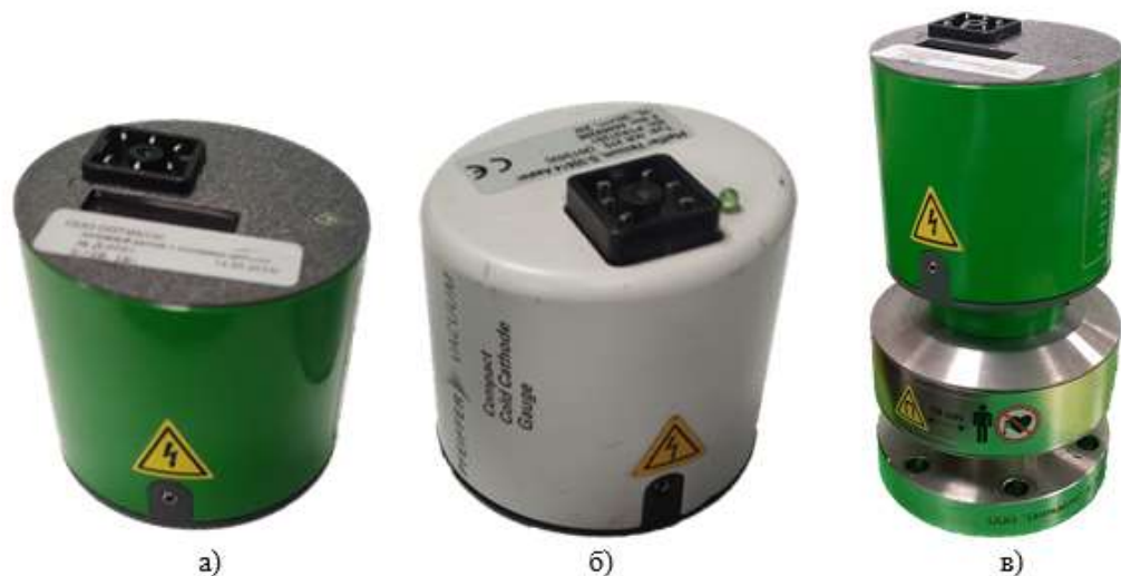
Рисунок 3. Измерительный блок нашей разработки (а), оригинальный блок Pfeiffer (б), активный датчик нашей разработки (в).
